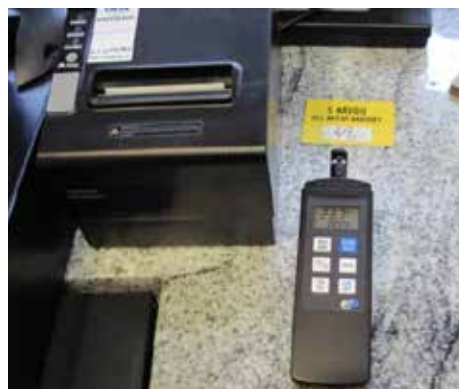
Obrázek 29 Orientační měření mikroklimatických podmínek přenosným přístrojem H560 DewPoint Pro II
