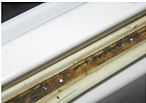
V těsněních chladicího zařízení se při nedostatečném úklidu vytváří nánosy nečistot, které mohou být zdrojem nežádoucích mikroorganismů
